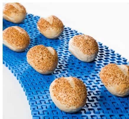
Tip MD 254 GAP%48 -površina je 48%otvorene izvedbe, preporučuje se za rashladnu traku u pekarama. Materijal je POM, do +110°C je otporan na toplotu, sa izvanrednim karakteristikama na habanje. Preporučuje se i za pranje povrća.
