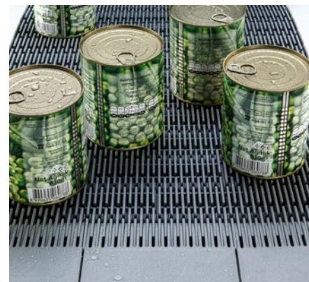
Rebrasti i vodopropusni HP 508 RR tip se preporučuje za konzervnu industrijsku primenu kod termičkih obrada. Zahvaljujući PP materijalu otporan je i na kuvanja.
