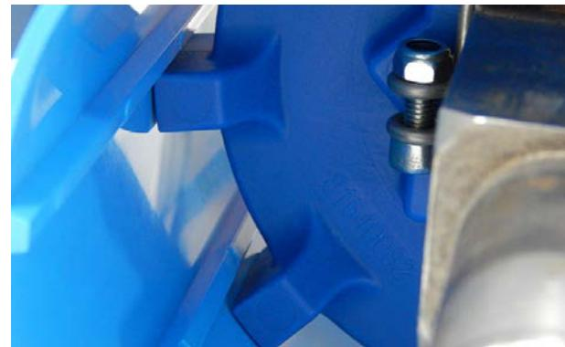
Kod **SuperDrive®** transportnih traka, pogon se ostvaruje putem integrirana rebra smještena uzdužno cijelom dužinom remenje, tj. rebrastih pogonskih valjaka. Transportna traka ne klizi, odnosno zahvaljujući rebrastim vodilicama eliminira bočno pomeranje trake. Traka zahtijeva minimalnu napetost, što daje mogućnost korištenja stroja jednostavnije konstrukcije.
