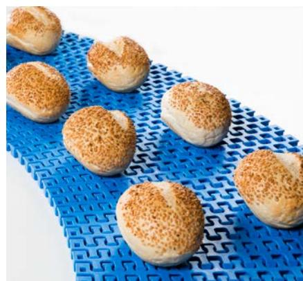
Tip MD 254 GAP 48% -površine je 48% otvorene izvedbe, preporučuje se za rashladnu traku u pekarama. Materijal je POM, otporan je na +110°C temperaturu, s izvanrednim karakteristikom trošenja. Također, preporučuje se i za pranje povrća.
